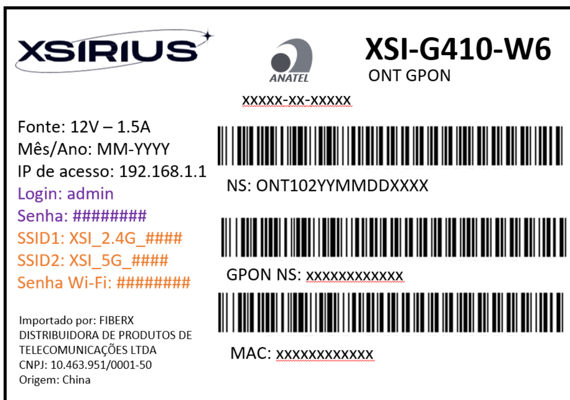
Figura 5: Imagem do adesivo por baixo do dispositivo
